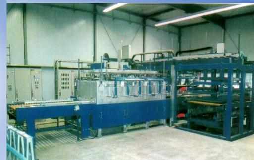
プレス式のローラー型加熱炉風冷強化ユニットにより、曲げた後に強化も可能なため建築用等幅広い用途にご利用頂けます。
