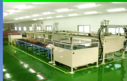
スマートフォン用カバーガラスなど風冷強化では不可能な薄板、小寸法ガラスを強化可能。強化による軟化変形、反りが発生しません。
