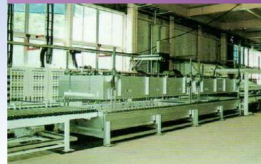
一般的な板ガラスの3~5倍程度の強化ガラスを製造可能な風冷強化装置。大型サイズにも対応可能。
