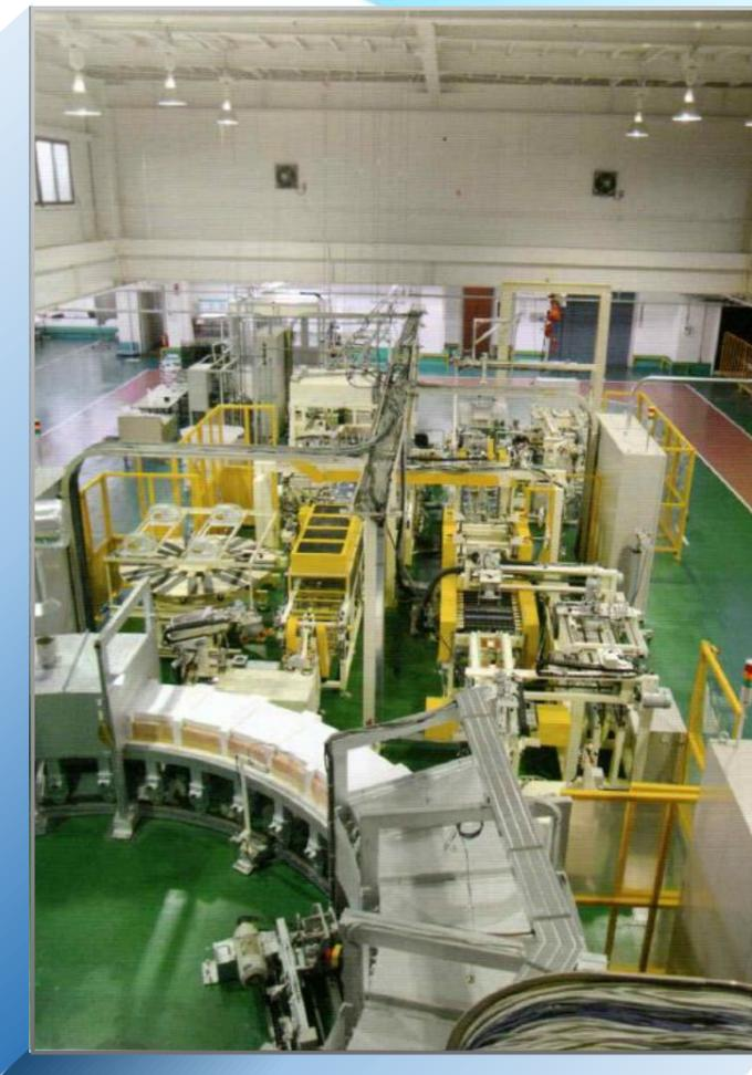
パレット投入機、切断機、洗浄機、ガラス曲げ成形機、異型切断、面取り機などを一体で運用しています。
